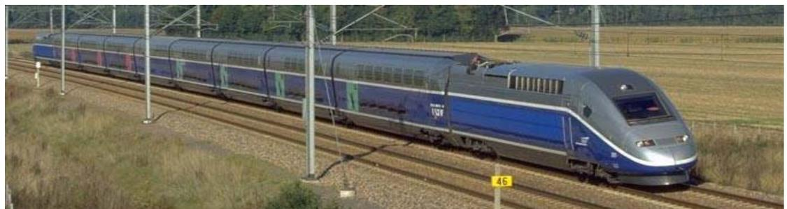
Le passage d'une rame 1N à une rame 2N entraîne en théorie une augmentation de  $\sim 14\%$  de la traînée globale de la rame
